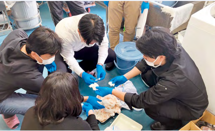
使用済紙おむつを洗浄後に取り出して、目視に加え、検査機も使いながら、臭いや菌の量を測っています。
